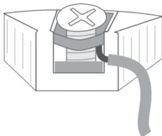
Провод монтируют между пластинами.
